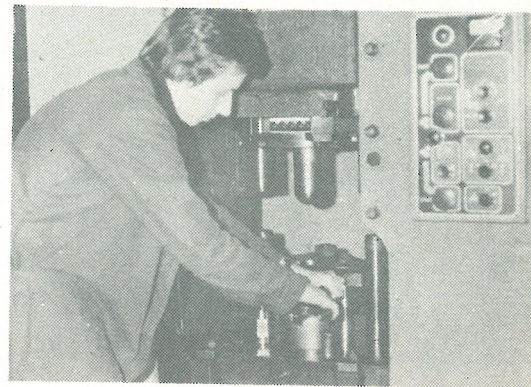
Zkušební zařízení pro zkoušení plechů na katedře tváření a plastů
